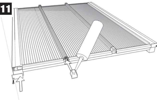
Die offenen Enden der Kupplungen werden mit PC Silikon versiegelt und die PC-Abschlusskappen aufgedrückt. Die seitlichen Abschlussbleche sind durch Schrauben mit dem seitlichen Profil zu verbinden.
