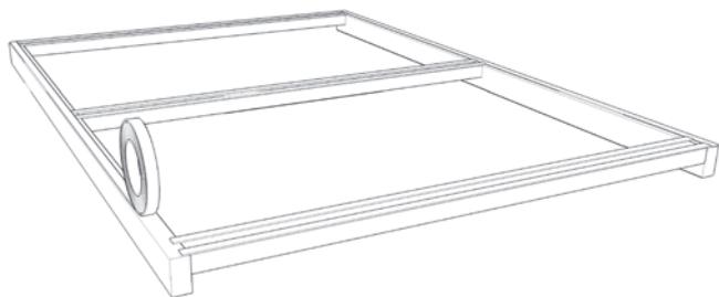
Die bauseitige Unterkonstruktion oder die Aluminium-Rahmenprofile sind durchgehend mit einem Dichtband zu versehen. So können Unebenheiten ausgeglichen und Kontaktkorrosion zwischen Aluminium und der Stahlunterkonstruktion vermieden werden. Die Mindestdachneigung sollte 7° betragen.
