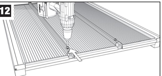
Das Dachsystem kann zusätzlich durch Schrauben mit angeformter Dichtscheibe gesichert werden. Hierzu muss die Schraubverbindung durch die Kupplung der Paneele ca. 20 % größer vorgebohrt werden.
