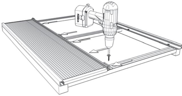
Das erste Paneel wird in das seitliche Rahmenprofil geschoben. Anschließend wird der Flachsoganker auf die Unterkonstruktion aufgesetzt. Dabei ist darauf zu achten, dass dieser an der Feder anliegt. Der Soganker ist mit einer Flachkopfschraube Schraube, A2 4,2 x 32 mm mit der Unterkonstruktion zu verschrauben.
