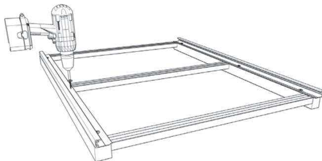
Das seitliche Aluminiumprofil muss ca. 5 mm länger sein als das Paneel. Das Profil sollte alle 30 – 50 cm ca. 20 % größer als der Schraubendurchmesser vorgebohrt werden, damit die Ausdehnung des Aluminiumprofils gewährleistet ist. Bei einem Stoß ist darauf zu achten, dass eine Dehnfuge von ca. 3-5 mm (dieser Wert gilt für eine Einbautemperatur von +20°C) vorhanden ist. Die Dehnfugen sind mit PC-Silikon abzudichten.
