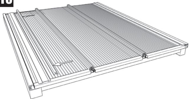
Nachdem das letzte Paneel gesetzt wurde, wird die Aluminium-Klemmleiste in das Rahmenprofil gesteckt bis diese hörbar einrastet. Anschließend wird die Dichtung eingedrückt. Hierbei ist darauf zu achten, dass die Dichtung nicht gedehnt, sondern gestaucht angebracht wird, um eine eventuelle temperaturbedingte Schrumpfung zu verringern.
