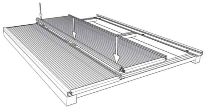
Die weiteren Paneele müssen ausgerichtet und an der Nut-und Federverbindung zusammen gefügt werden bis sie hörbar einrasten.
