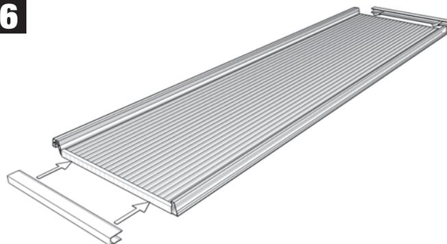
Die Abschlussprofile werden mittig auf beide Stirnseiten der Paneele gesteckt. Es ist darauf zu achten, dass die Tropfkante des U-Profils nach unten zeigt.
