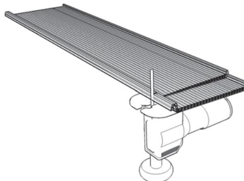
Die Paneele können mit handelsüblichen Werkzeugen, wie Stich- oder Kreissägen mit fein gezahnten Sägeblättern zugesägt werden. Anfallende Späne sollten mit öl- und wasserfreier Druckluft entfernt werden. Falls die Paneele nicht auf Maß zugeschnitten geliefert wurden, müssen die Paneele auf das gewünschte Maß gekürzt werden.
