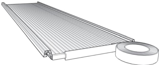
Die Stirnseiten der Paneele sind abzukleben. Die Stirnseiten können entweder beidseitig mit Alu-Tape, oder mit Alu-Tape an der unteren Stirnseite und mit einem anderen Tape an der oberen Stirnseite abgeklebt werden.
